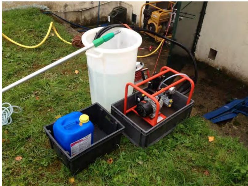
*Appareil de nettoyage des réservoirs*
