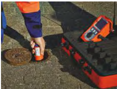
Figure 16 : Matériel de recherche de fuite
