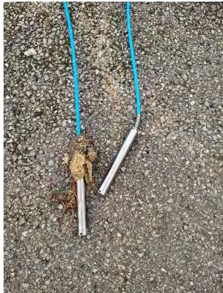
Figure 155 : Renouvellement de la sonde de niveau du PR « PASSERELLE » à Rantigny (VEOLIA)
