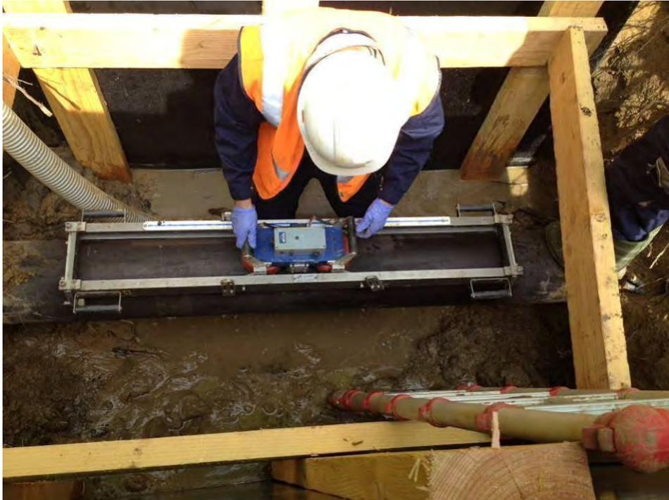
Figure 53 : Scan de la canalisation
