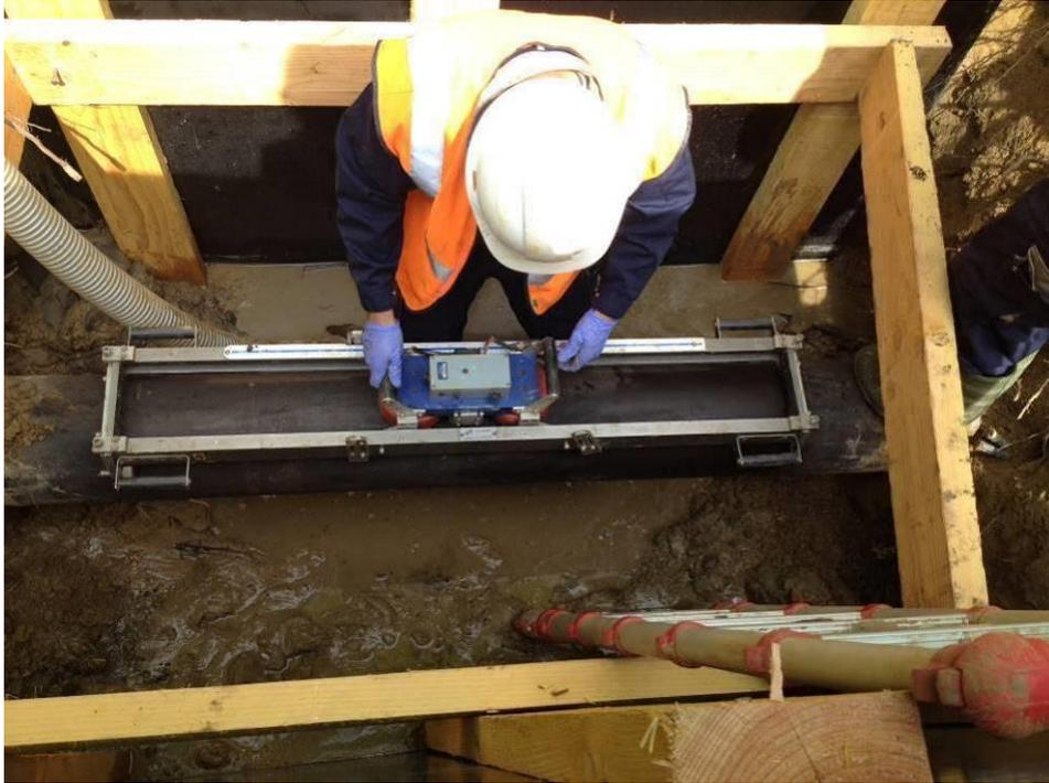
**Figure 59 : Scan de la canalisation**
