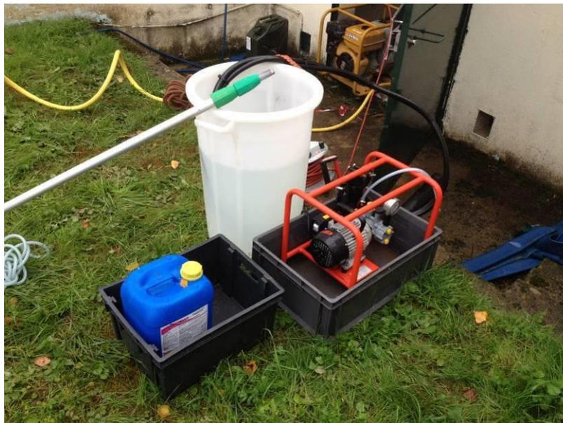
**Figure 43 : Appareil de nettoyage des réservoirs**
